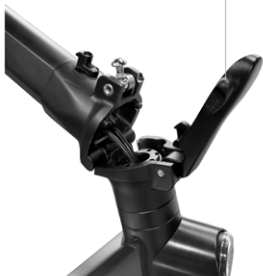
Palanca del mecanismo de bloqueo
